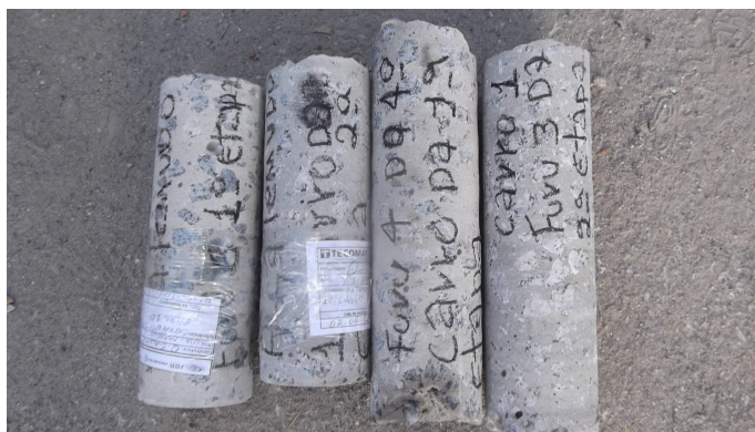
Figura 41 - Amostras de testemunhos extraídos do pilar e do bloco de estacas. (Viaduto Capitão Temudo).
