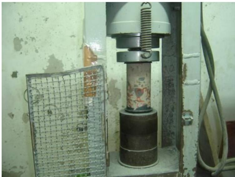
Figura 2.13 – Ensaio de ruptura à compressão axial do corpo de prova. (Fonte: DELTACON ENGENHARIA, 2011).
