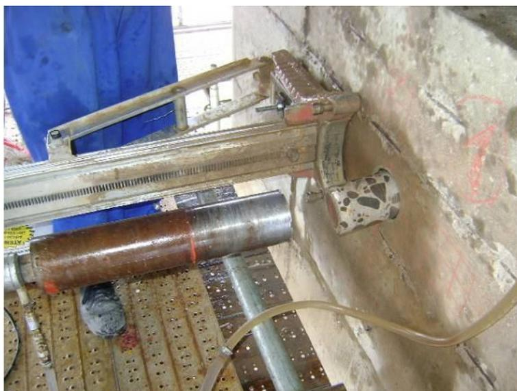
Figura 2.12 – Extração de corpos de prova cilíndricos de uma estrutura de ponte. (Fonte: DELTACON ENGENHARIA, 2011).
