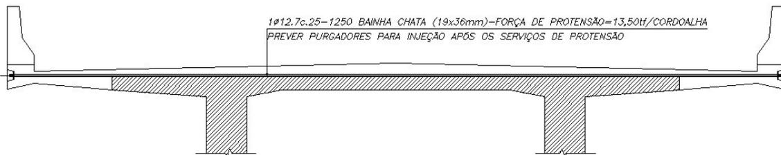
Figura 3.18 – Posicionamento e especificação da armadura transversal de protensão para o alargamento e reforço da laje do tabuleiro. (Fonte: VITÓRIO, 2013)
