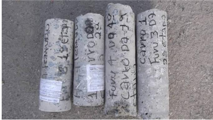
Figura 3.31 - Amostras de testemunhos extraídos do pilar e do bloco de estacas. (Fonte: VITÓRIO, 2014)
