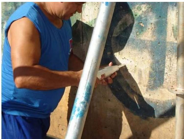
Figura 2.14 – Ensaio de esclerometria em pilar de ponte. (Fonte: DELTACON ENGENHARIA, 2011).
