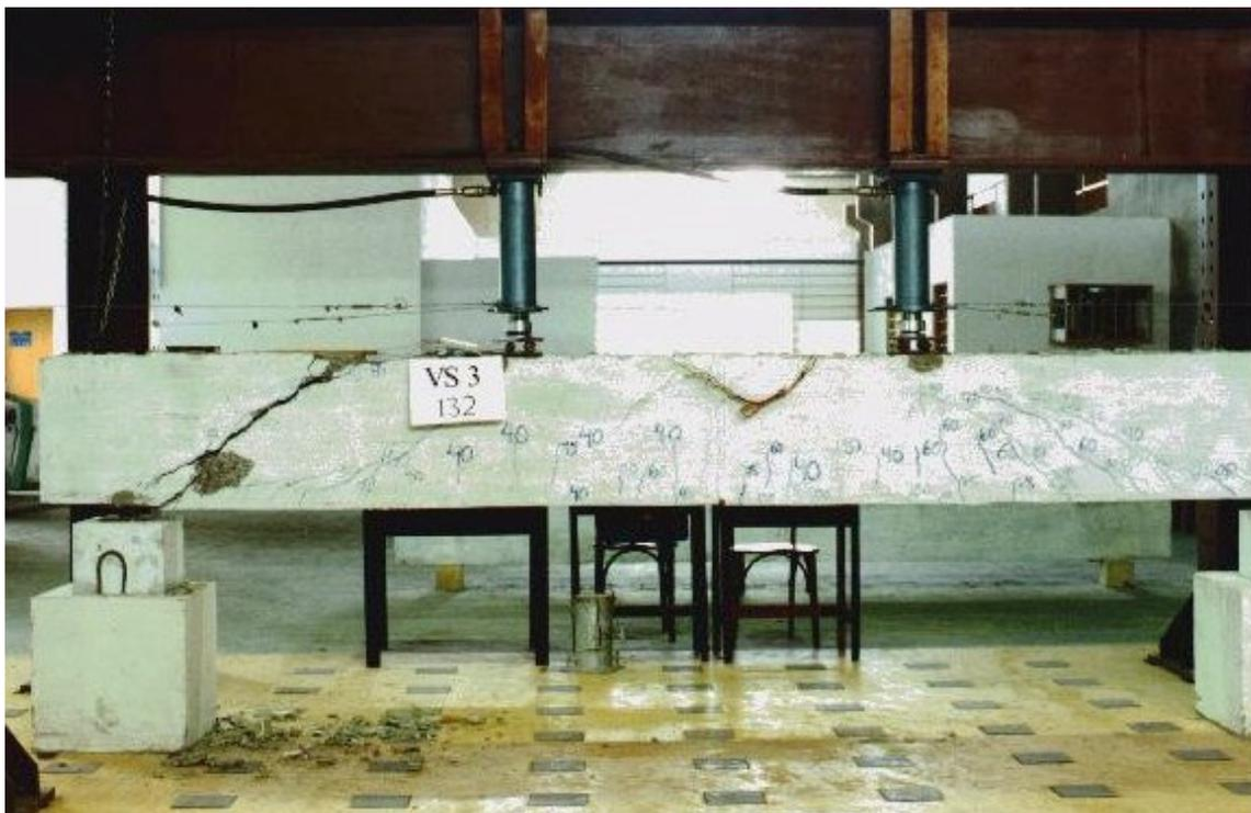
Foto 14 - Colapso do protótipo VS3 ( face posterior ).
