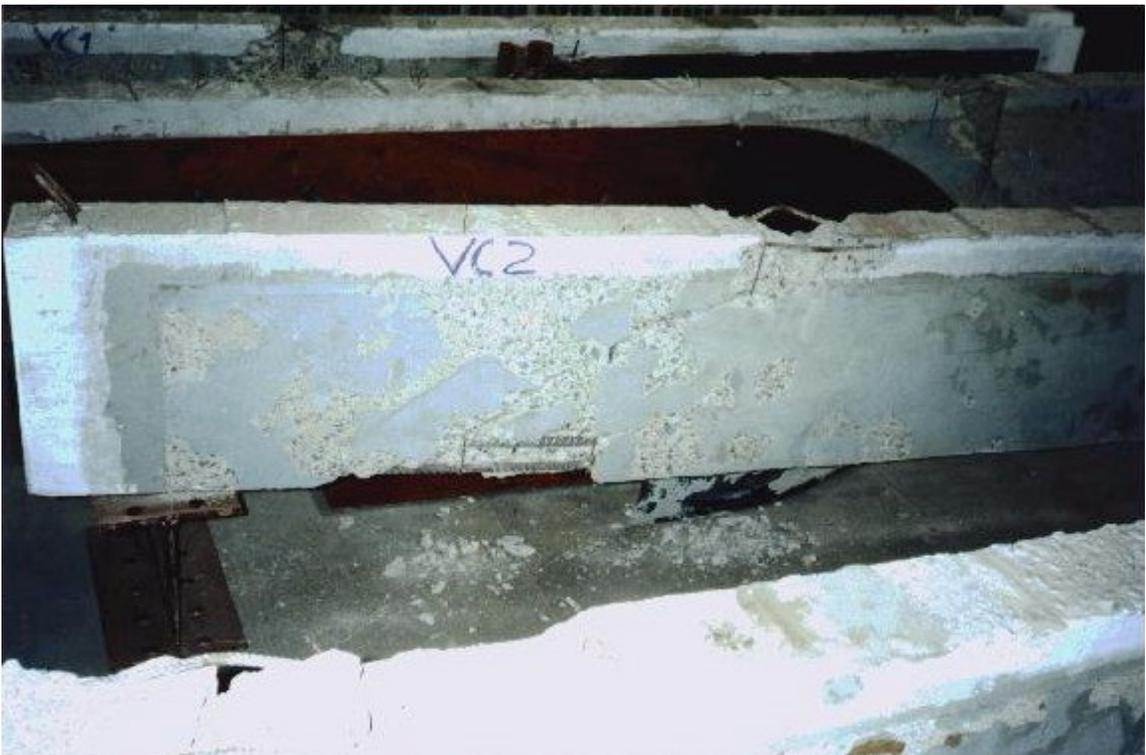
Foto 12 - Detalhe da ruptura do protótipo VC2.
