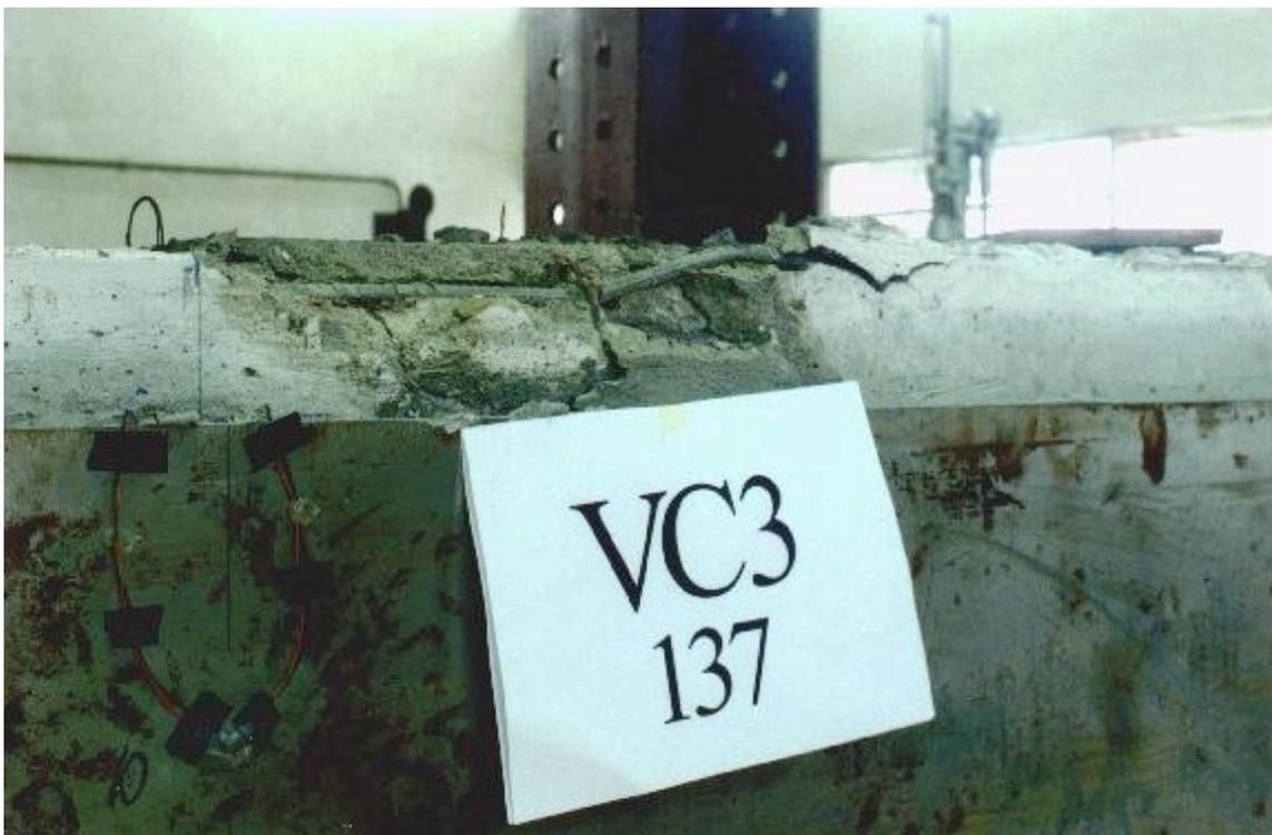
Foto 24 - Vista superior da ruptura da viga VC3 ( flambagem da armadura de compressão ).
