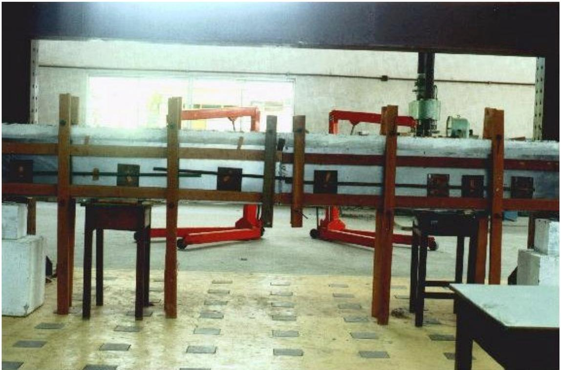
Foto 6 - Sistema utilizado para pressionar as chapas sobre as superfícies laterais da viga.
