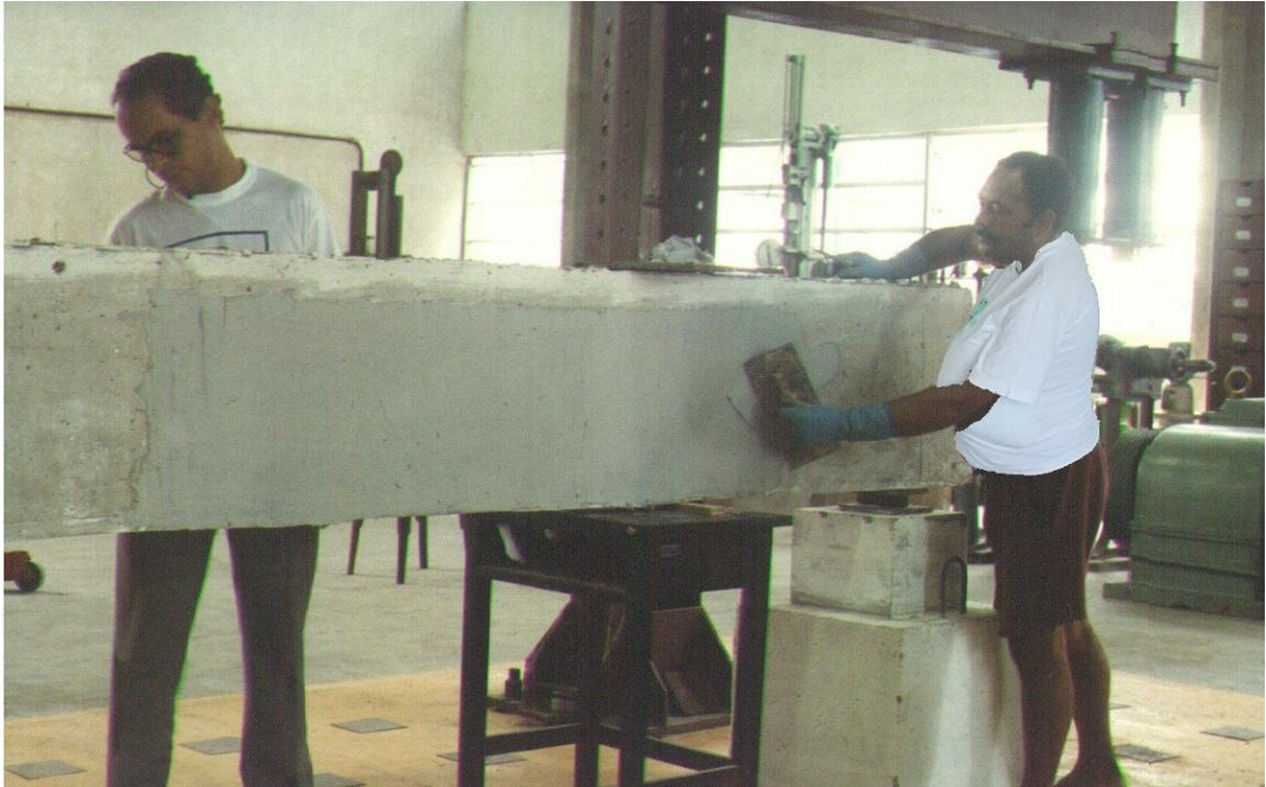
Foto 5 - Aplicação do adesivo epóxi na viga.
