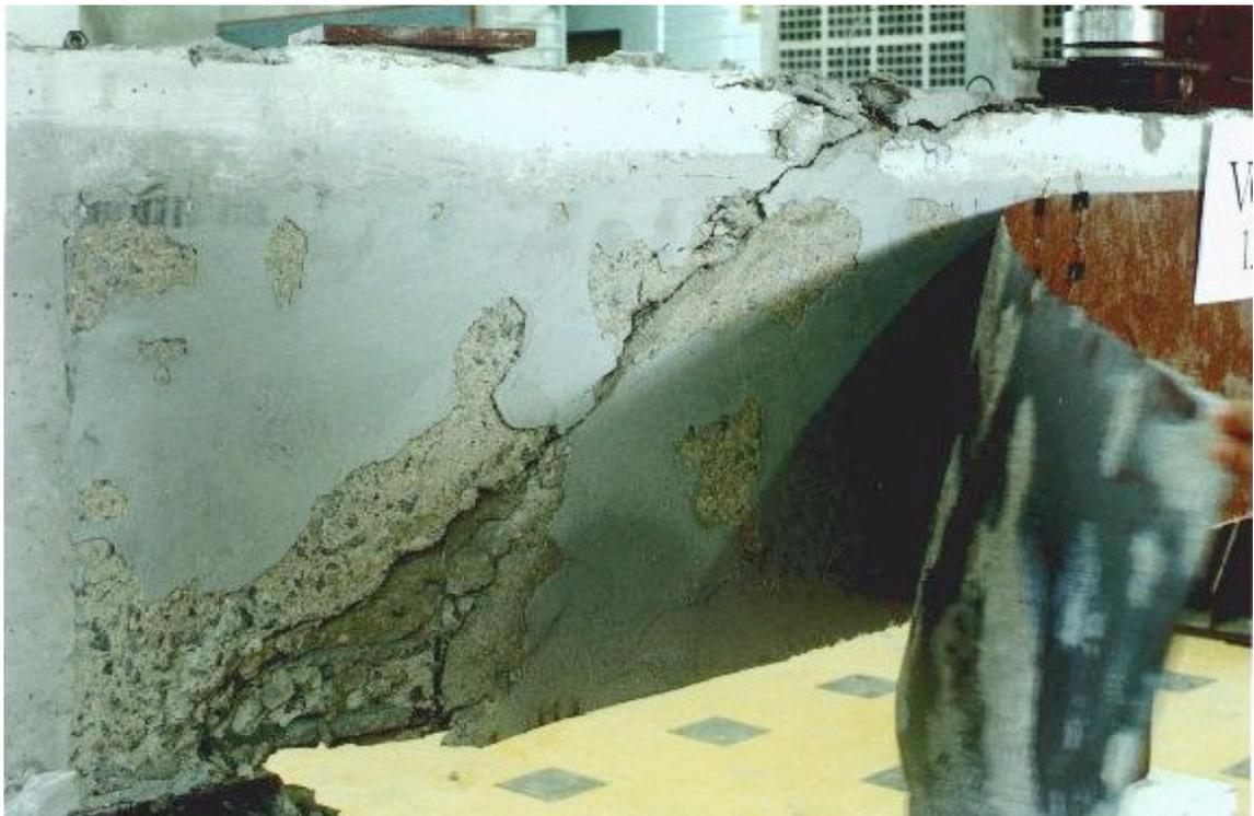
Foto 16 - Detalhe da ruptura do protótipo VC3.
