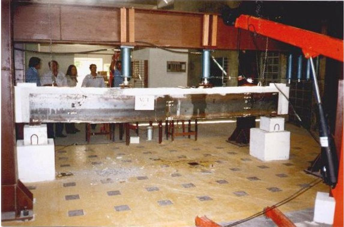
Foto 9 - Colapso da viga VC1.
