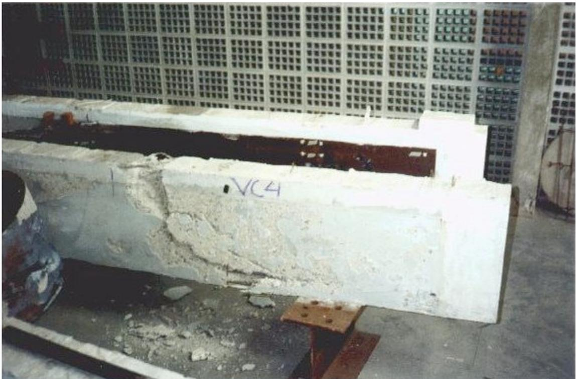
Foto 18 - Detalhe da ruptura do protótipo VC4.
