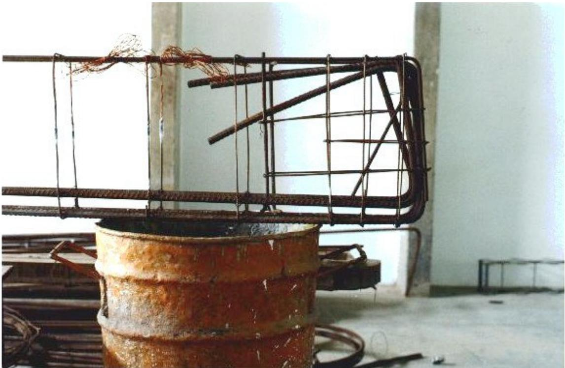
Foto 2 - Armaduras dos protótipos e localização dos extensômetros elétricos nos estribos.
