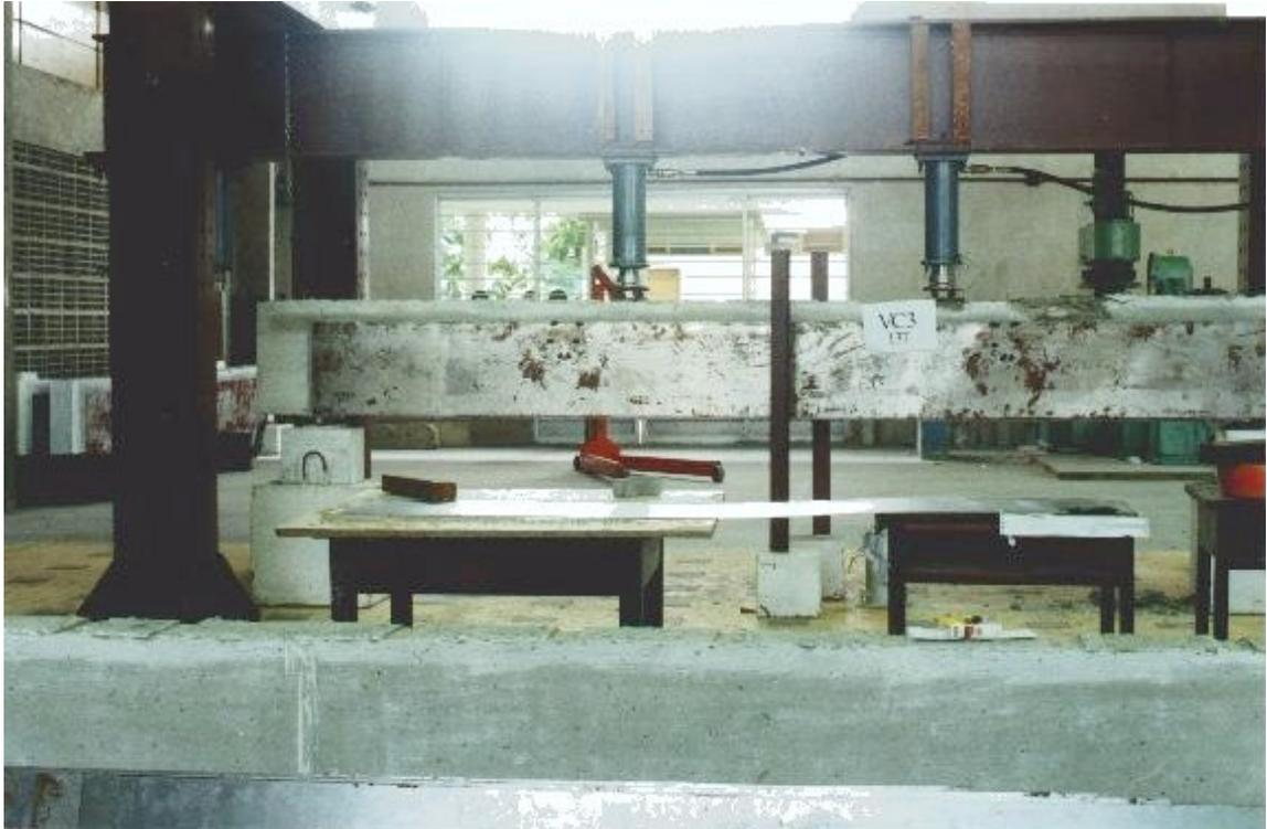
Foto 15 - Colapso da viga VC3.
