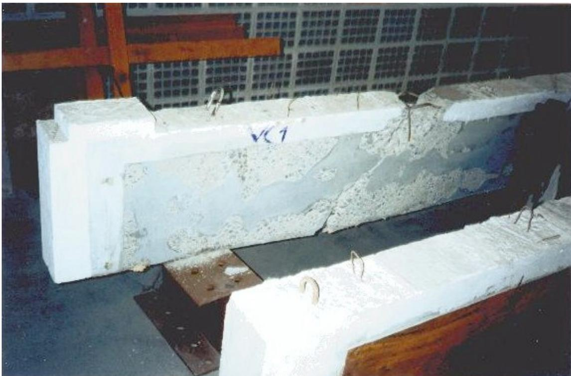
Foto 10 - Detalhe da ruptura do protótipo VC1.
