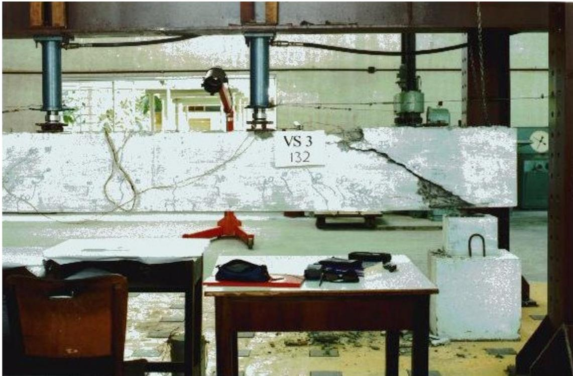
Foto 13 - Colapso do protótipo VS3 ( face anterior ).
