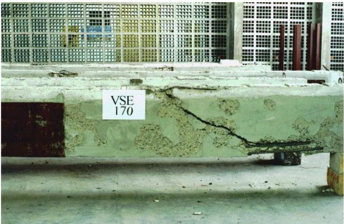
Foto 20 - Detalhe da ruptura da viga VSE ( face posterior ).
