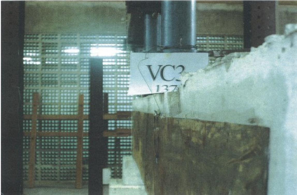
Foto 23 - Vista lateral da ruptura da viga VC3 ( descolamento da chapa ).
