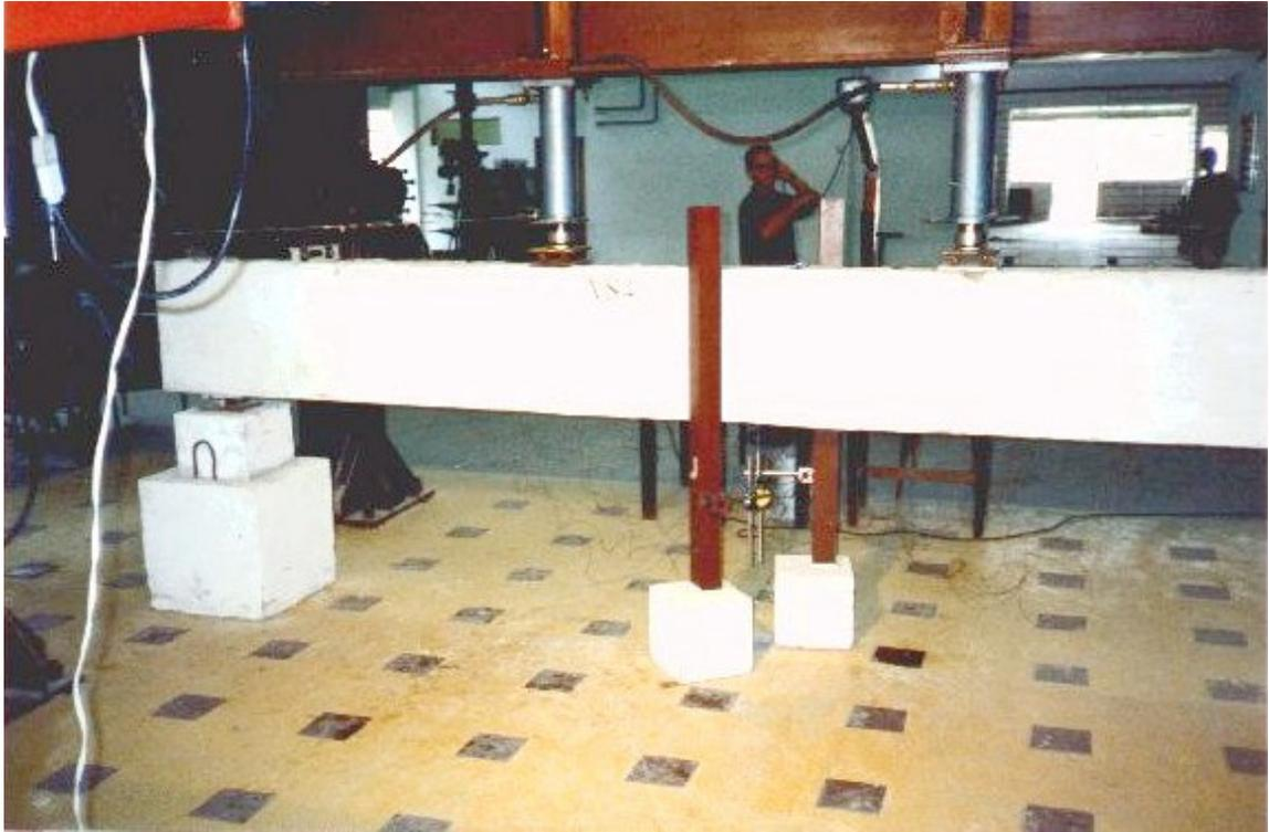
Foto 7 - Posicionamento dos flexímetros nos ensaios.
