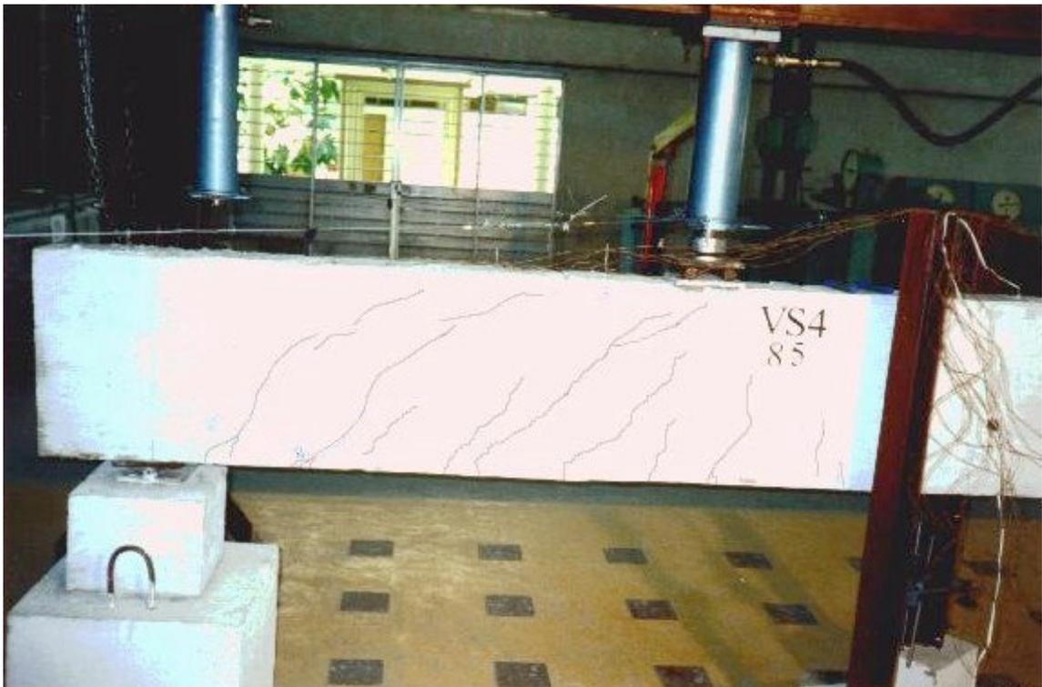
Foto 8 - Fissuras de cisalhamento apresentadas no final do ensaio de uma viga sem chapas.
