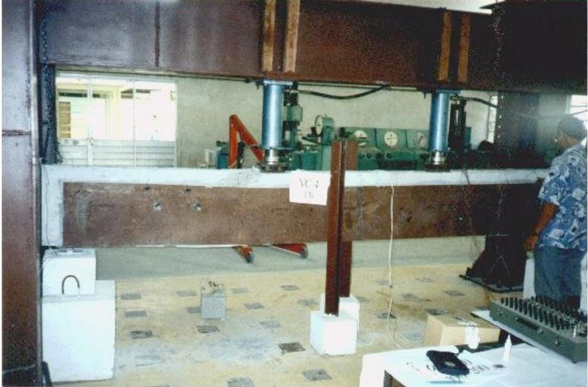
Foto 17 - Colapso da viga VC4.
