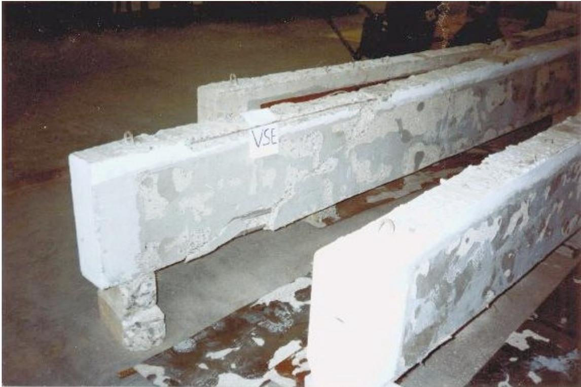
Foto 19 - Detalhe da ruptura da viga VSE ( face anterior ).
