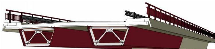
Figura 1.8 – Corte esquemático de um tabuleiro com vigas caixão e laje de concreto. (Fonte: MARQUES, 2011)
