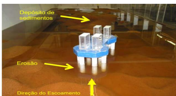
Figura 1.12 - Modelo físico em laboratório com modelagem numérica para determinação da profundidade de erosão em torno dos pilares de uma ponte. (Fonte: VASQUEZ e LIMA, 2009)
